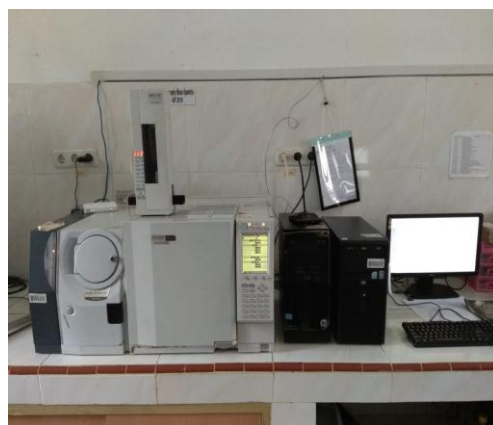
Gambar 1.19 Proses Analisa Kromatografi Gas Spektrometer Massa
